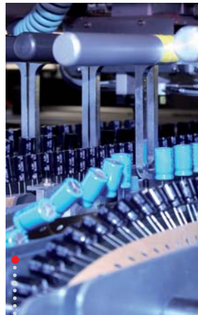
TRANSPORTBÄNDER führen die Einzelteile zu den Bestückungsautomaten.
