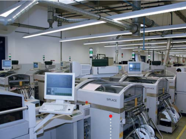
PLATINENBESTÜCKUNG Per Computersystem wird die Produktion von Platinen überwacht und gesteuert.
