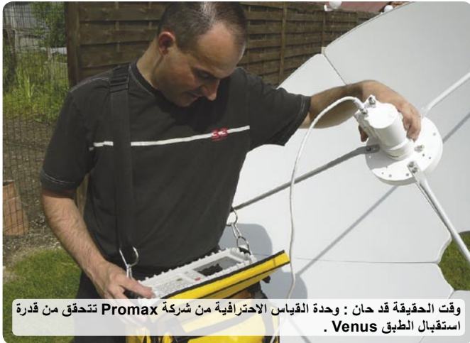
ما هو نوع وحدة خفض الشوشرة؟ قامت الشركة المنتجة PT Subur Semesta بتزويد الطبق بحلقة مصغرة و بهذا يمكن تغيير C band بأخرى من نوع Ku band.
