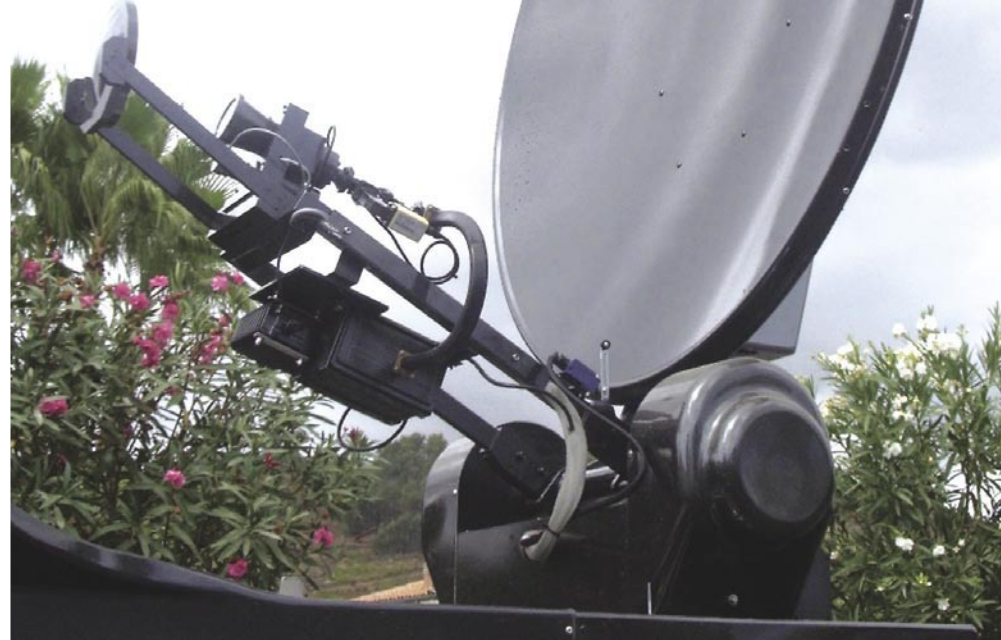
طبق بقطر 150سم متحرك يفتح بطريفة آلية ليجد القمر الصناعي أوتوماتيكيا
