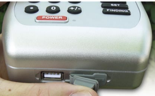
منفذ USB للتوصيل بجهاز الكمبيوتر بجوار مقيس مزود الطاقة
