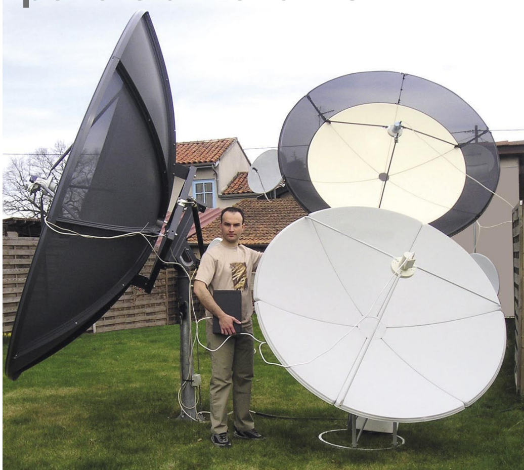
Sylvain Oscul настройва своята параболична 1.8м антена. Той може да сравни приемането с другите две антени, имащи диаметър 2.40м и 3.10м.
