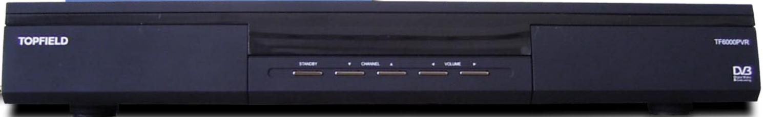
An der Frontseite befinden sich 5 Tasten zur Bedienung des Receivers ohne Fernbedienung, in der Mitte prangt das große und vor allem sehr gut lesbare VFD Display und ganz rechts finden sich gut versteckt hinter einer Klappe 2 CI Schächte zur Aufnahme der Entschlüsselungsmodule. Dabei werden alle gängigen Typen also Irddeto, Seca Mediaguard, Viaccess, Nagravisio, Conax, Cryptoworks etc. unterstützt.
