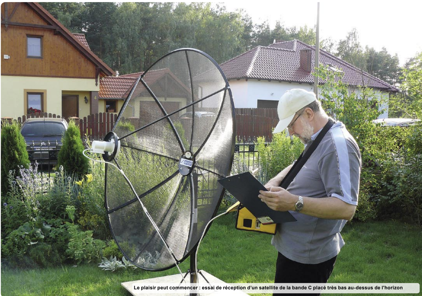
Il est temps d'aligner l'antenne. Nous recommandons d'employer un niveau à bulle équipé d'une échelle d'angles – cela facilitera le réglage de l'altitude.
