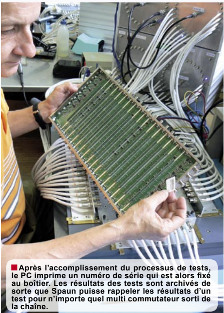
■ Chaque multi commutateur est testé sur des fonctions multiples. Le multi commutateur est insérée dans cette station d'essais et en déplaçant un levier unique tous les connecteurs de « F » sont insérés et le processus de tests peut commencer.
