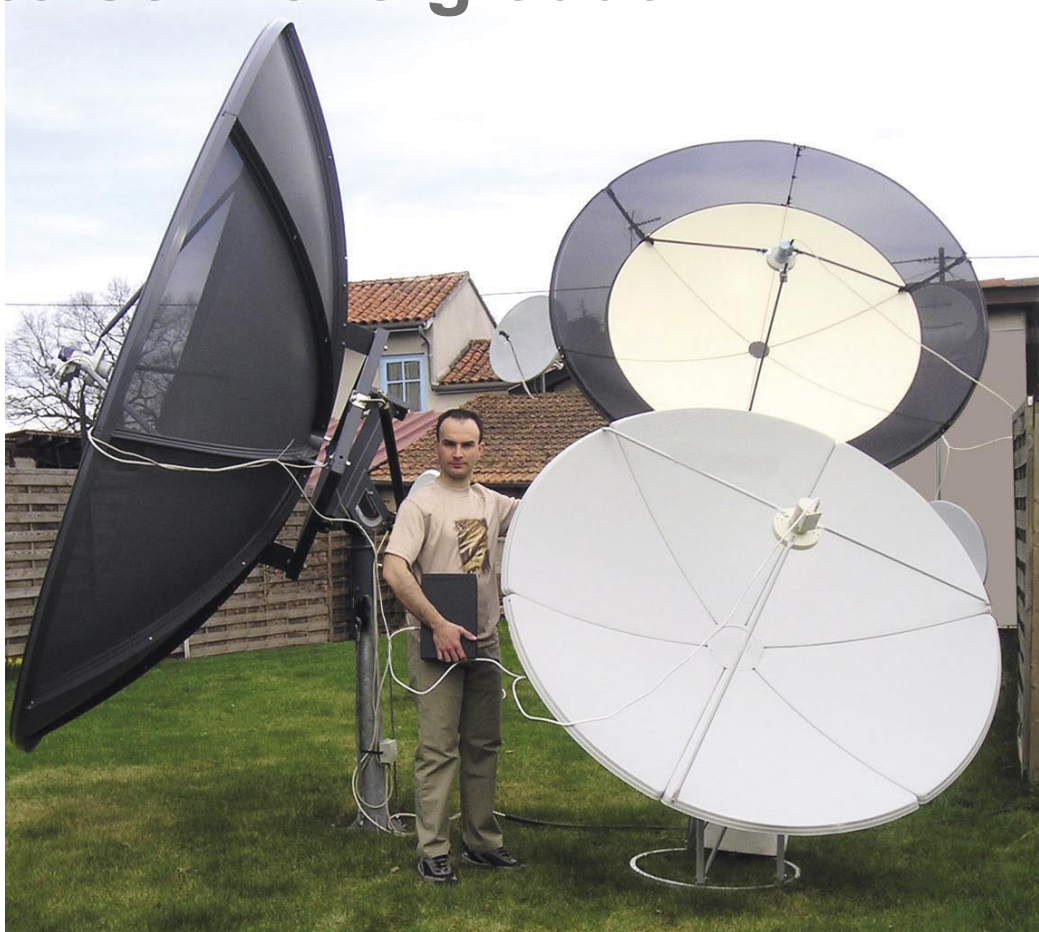
Sylvain Oscul podešava prime focus antenu promjera 1,8 m. U mogućnosti je provjeriti prijem preko svojih antena od 2,4 m i 3,1 m.
