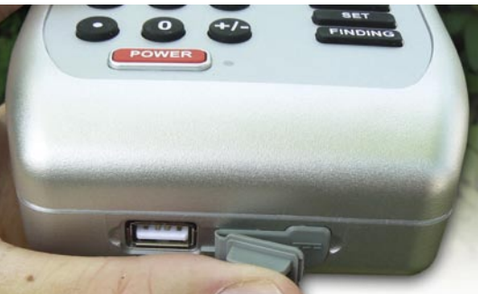
Cihazı bilgisayar bağlamak için kullanacağınız USB arabirimi güç girişinin hemen yanında
