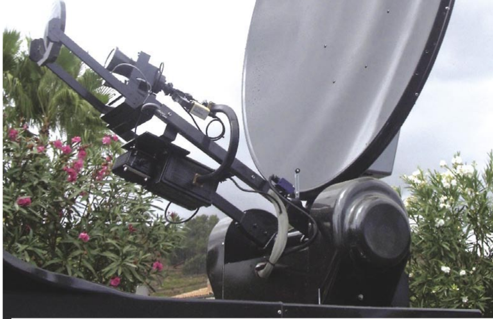
Sistemin 150 cm'lik çanağı motorlu ve uyduyu otomatik olarak kendisi buluyor.
