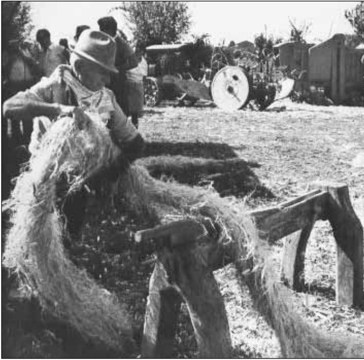
Gramolatura. Metodo per maciullare la canapa, allo scopo di separare le fibre tessili da quelle legnose.
