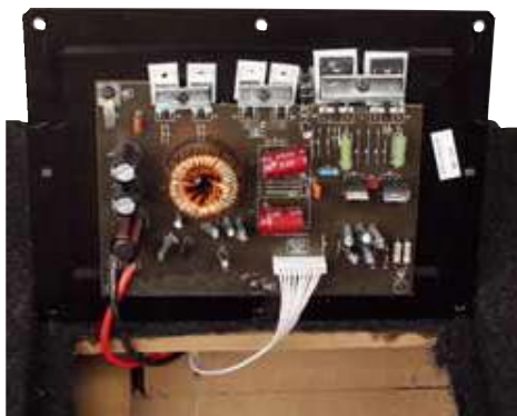
Das Endstufenteil im Gehäusedeckel beherbergt eine kleine Monoendstufe, die traditionell im Class-A/B-Betrieb arbeitet
