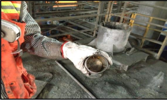
Inyección de Trazador Radiactivo
