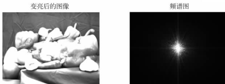
图 5-5 灰度图像变亮后进行傅里叶变换
