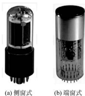
图 5-7 光电倍增管光窗类型
