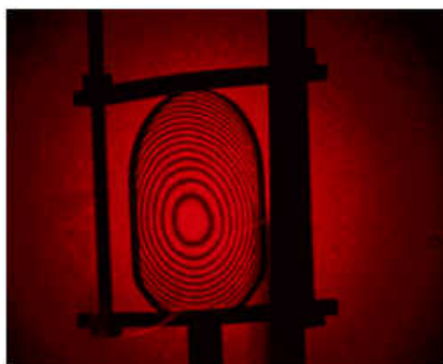
Figura 9.8. Configuración interferencial de un interferómetro de Michelson.
