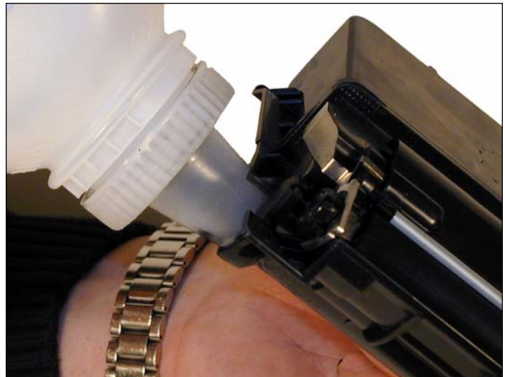
25. Fill hopper with E120 toner, replace the fill plug.
