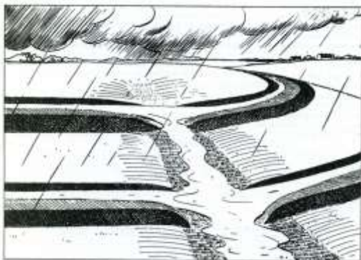
Figura 5.11.a: Esquema de terrazas de desagüe con canal de evacuación central (Tomado del Engineering Field Manual, SCS., 1984)
