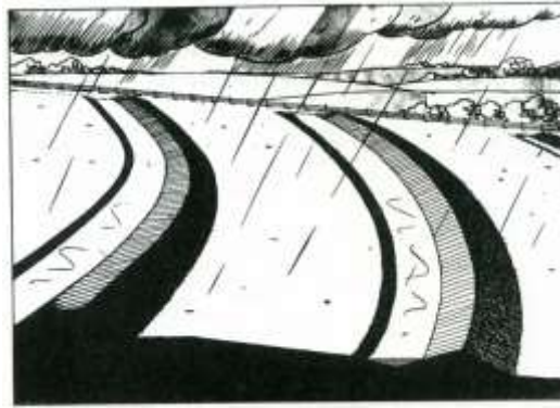
Figura 5.12.a: Esquema de terrazas de absorción (Tomado del Engineering Field Manual, SCS. 1984)
