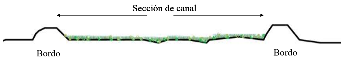
Figura 6.5: Sección transversal esquemática de un canal de bordos.
