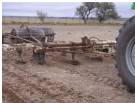
Figura 4.52: Descompactador con reja alada, cuchilla corta rastrojo y rolo emparejador de terreno (SECyOT-UNRC). Figura 4.53: Prueba del prototipo reja-cero (SECyOT-UNRC).
