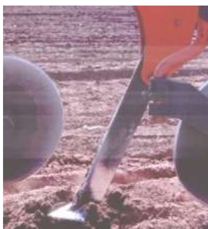
Figura 4.50: Prototipo reja-cero® desarrollado por la UNRC (SECyOT-UNRC).
