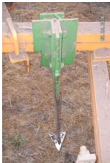
Figura 4.49: Detalle de reja descompactadora alada con base angosta (SECyOT-UNRC).
