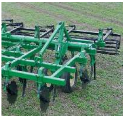
Figura 4.52: Descompactador con reja alada, cuchilla corta rastrojo y rolo emparejador de terreno (SECyOT-UNRC). Figura 4.53: Prueba del prototipo reja-cero (SECyOT-UNRC).
