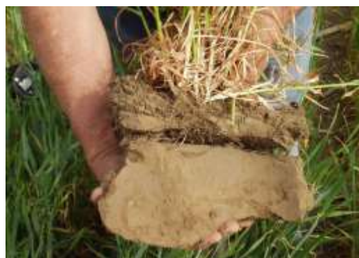
Figura 4.9: Impedancia mecánica superficial en un Hapludol típico de la Serie Ordoñez, con un cultivo de trigo (SECyOT-UNRC).
