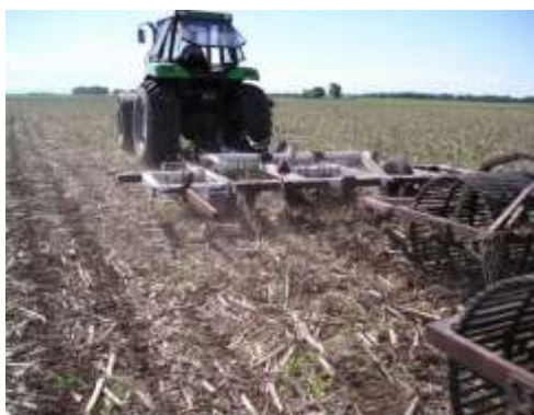
Figura 4.56: Conjunto tractor-escarificador descompactador-rollo, trabajando sobre un rastrojo de maíz (SECyOT-UNRC)
