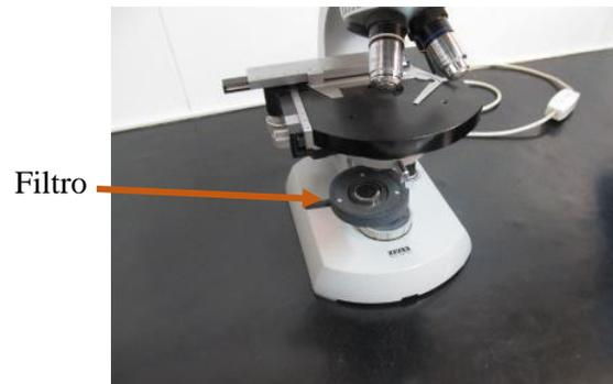
Figura 19. Microscopio común con filtro retráctil, al colocarlo permite observar como uno de campo oscuro.
