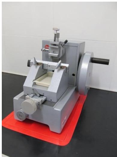
Figura 14. Micrótopo tipo Minot.
