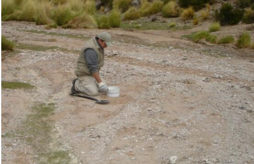
Muestreo de sedimentos en lecho de arroyo seco
