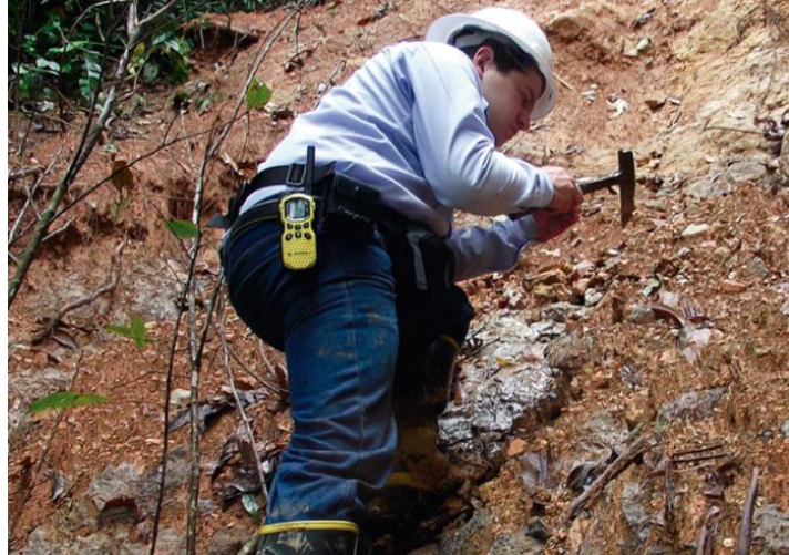
Muestreo de roca en esquirlas (chips)
