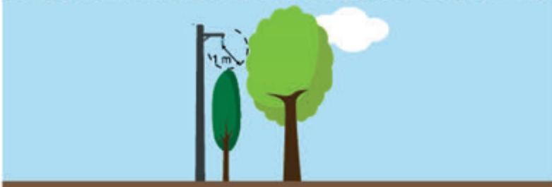
Enedis demande que l'élagage soit réalisé en augmentant d'au moins un mètre les distances prévues à la construction des lignes.
