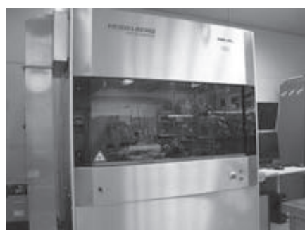
レーザーリソグラフィ装置
