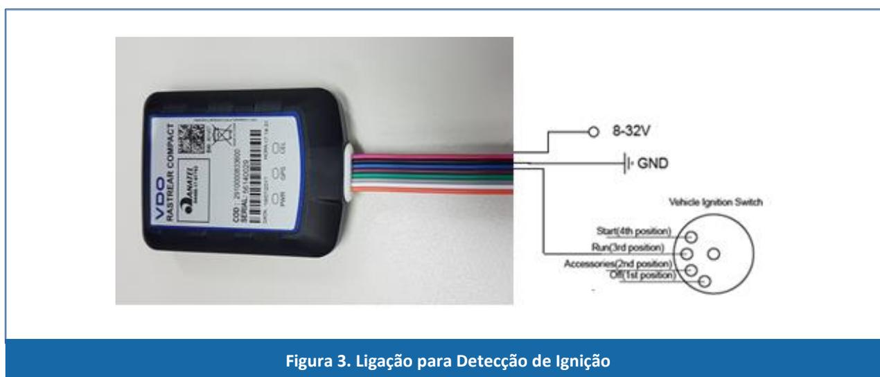
O cabo azul é utilizado para a detecção de ignição. É altamente recomendável conectar este cabo à chave de ignição na posição "RUN" como mostrado a figura acima.
