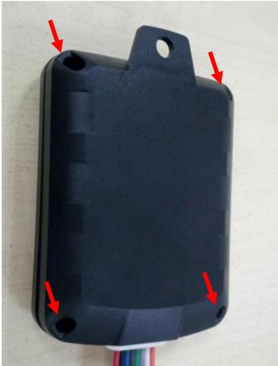
**Passo 5:** Aperte os 4 parafusos da tampa traseira. Em seguida coloque as borrachas.
