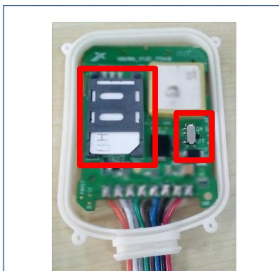
**Passo 3:** Inserir o SIM card conforme figura acima e volte a chave para **ON** em seguida.
