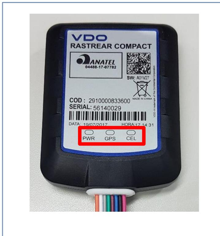
Figura 8. LEDs Indicadores do Rastrear Compact
