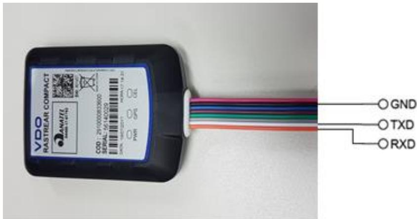
Figura 7. Conexão do UART com Dispositivos Externos
