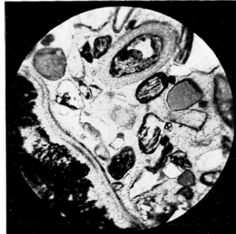
Fig. 17 Spaltsinterbreccie. In langgestreckte Hohlräume des Spaltsinters wurden Erbsen eingeschleppt, die als Bildungskern Basal/apifil haben, ferner graue Jura* kaJksf'ckchcn, Bohnerzkügelchen und Glimmerplättchen. Alles ist durch Calcit verkittet. 40x
