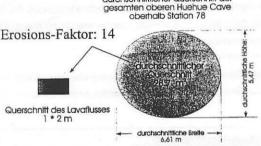
Abb. 6: Profil durch die Huehue Tube an Vermessungsstation 33 (Clague's Cave) (a) und geologische Interpretation des Geländebefundes (b). Durch Aufbruch in die hangende Lava der Mystery Tube und durch Erosion nach unten ist der durchschnittliche Querschnitt der Röhre um den Faktor 14 größer als der in der Röhre geflossene Lavafluss (c). An der Station 33 gibt es sehr große Lavastalagmiten, die auf einsickernde Mystery Lava zurückzuführen sind. (a, rechts).
