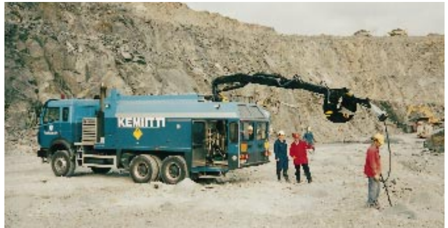
Outokumpu Chromen kaivoksella Keminmaalla otettiin käyttöön Vihtavuoren tehokas ja ympäristöystävällinen emulsioräjähdyssaine Kemiitti 510.
