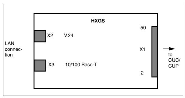
Figure 2-1 HXGS interfaces (S30810-Q2931-X/X100)
