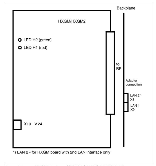
Figure 2-3 HXGM interfaces (S30810-Q2930/Q2940-X/X100)
