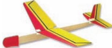
Ideales Einstiegsmodell für die Grundschule. Durch das Winkler - Stecksystem gehen die Tragflächen bei einer unsanften Landung nicht so leicht zu Bruch wie bei den üblichen starren Klebenähten. Alle Teile sind fertig ausgestanzt. Trimmen mittels verschieben der praktischen Nase aus Kunststoff, kein Blei notwendig.
