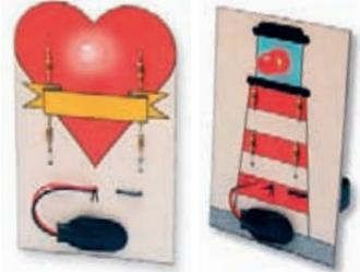
Eine rot blinkende Jumbo-LED (Ø 10 mm) bildet das Herzstück dieser beiden Lötübungen. Mit dem beiliegenden Material kann eine der beiden abgebildeten Schaltungen gebaut werden.
