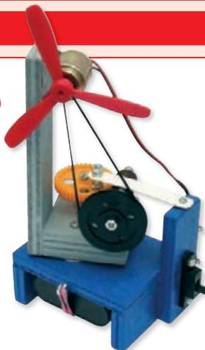
Ein Riemen- und ein Schneckengetriebe sorgen für eine langsame Schwenkbewegung (90°) des Aufbaues, während der große Ventilator Frischluft spendet.
