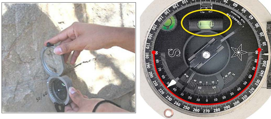
Figura 1.4. Medición del ángulo de buzamiento con la brújula Brunton
