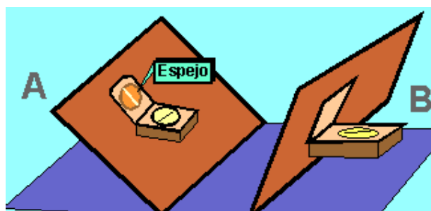
Figura 1.5. Obtención de dirección de buzamiento. A. En un plano inclinado. B. En un plano extraplomado.
