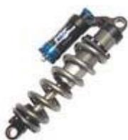
La elección de un muelle helicoidal para un amortiguador trasero de una bicicleta mountain bike viene determinado por nuestro peso y el porcentaje de SAG deseado, la geometría de la bicicleta y relación de desmultiplicación, la longitud total del amortiguador y el recorrido de suspensión.
