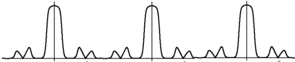
Espectro de mensaje muestreado con interferencia
