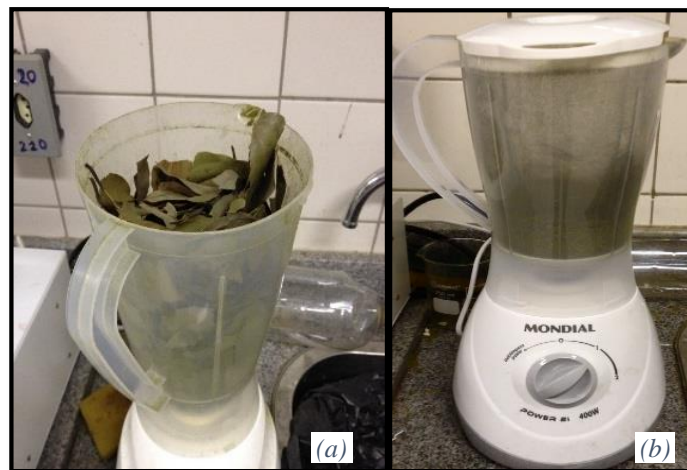
Figura 8 – Trituração das folhas da Cinnamomum hatschbachii . Legenda: (a) Inserção das folhas no equipamento; (b) Trituração das folhas. Fotos: C. A. L. Souza.
