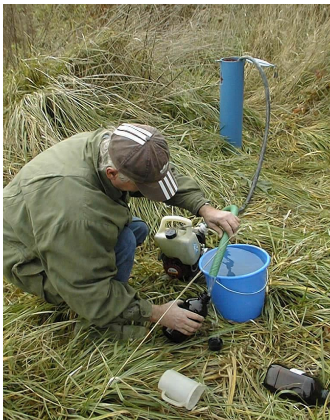
4-4 ábra: Mintavétel figyelőkútból vízminőség vizsgálathoz
