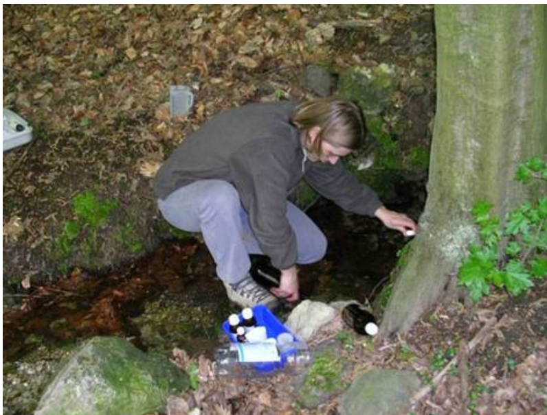
4-3 ábra: Merített mintavétel forrásból vízminőség vizsgálathoz
