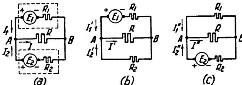
En (a) vemos el circuito a resolver y en (b) y (c) el mismo circuito en la que actúan independientemente los generadores, reemplazándose los eliminados por sus respectivas resistencias internas.
