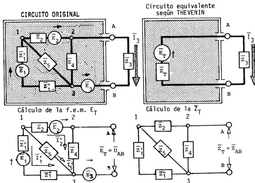
El método que desarrollamos, busca precisamente obtener el valor de la fuerza electromotriz  $E_T$  y la impedancia equivalente  $Z_T$ , elementos ambos que constituyen el generador equivalente de Thevenin.
