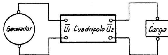
La figura nos sirve para apreciar como está ubicado un cuadripolo en una red. La relación entre la tensión de entrada  $U_1$  y la salida  $U_2$  se llama **relación de transformación**
