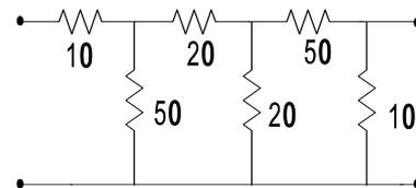
Para el cuadripolo T de la izquierda determinamos los parámetros  $A_1$ ;  $B_1$ ;  $C_1$  y  $D_1$ .
