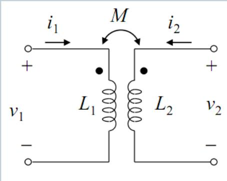
Energía almacenada por un inductor  $\Rightarrow w = \frac{1}{2} L i^2$
