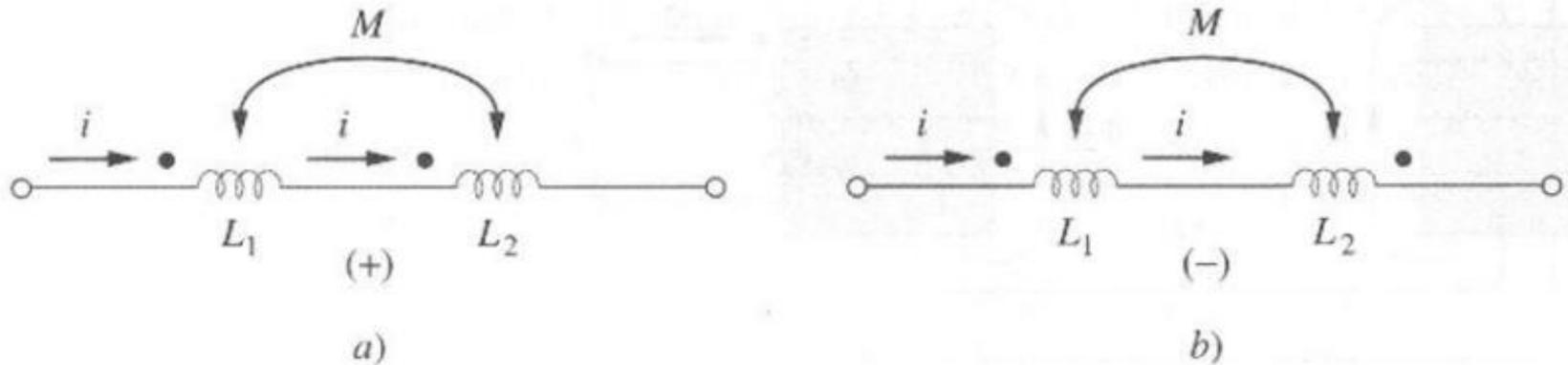
Convención de las marcas para bobinas en serie; el signo indica la polaridad de la tensión mutua: a) conexión en serie aditiva, b) conexión en serie opositiva.
