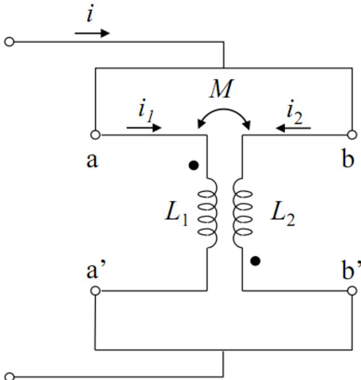
$$v_{aa'} = j\omega L_1 i_1 - j\omega M i_2$$
