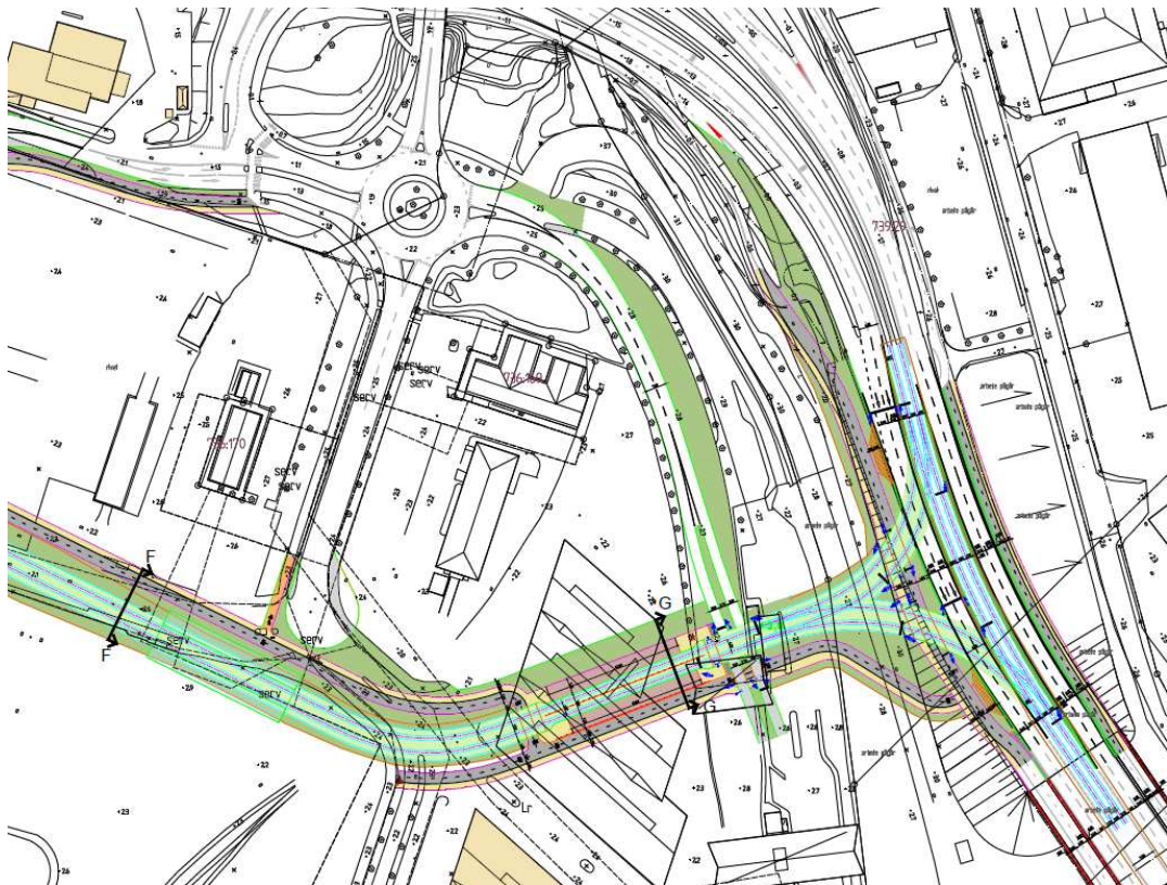
Figur 47. Uttag ur trafikförslaget ritning 202819-0002. Gatan Frihamnen stängs av och avslutas i en vändplats och fordonstrafik hänvisas istället till Frihamnspiren för att nå målpunkter söder om spårvägen.
