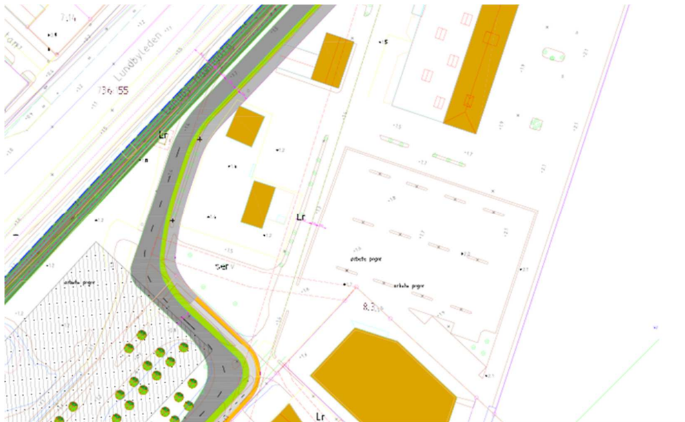
Figur 53. Utrett alternativ för vägdragnig i västra Frihamnen, anpassad till eventuell framtida exploatering och mark ägd och förvaltat av Göteborgs Stad.
