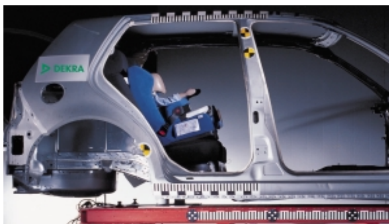
Dynamische Prüfung eines Kindersitzes.
