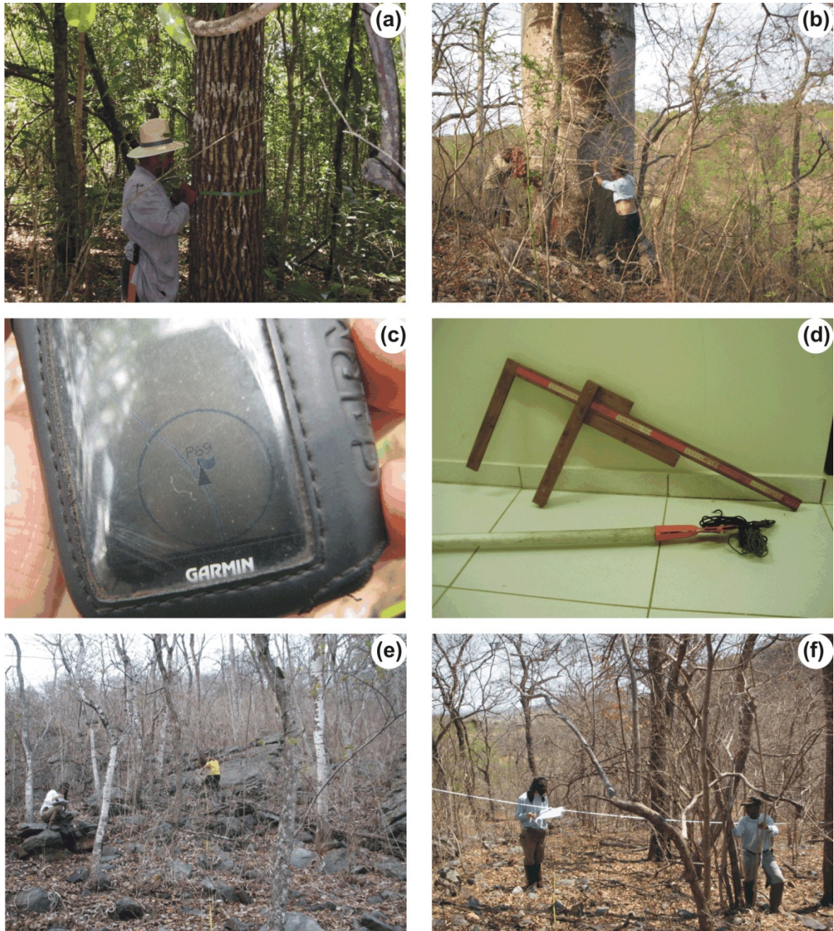
Figura 4. Procedimentos e material de campo para inventário florestal: (a) medição do fuste de Callophyllum brasiliense (Landim) com fita métrica em mata ciliar; (b) medição do fuste de Cavanillesia arborea (Baoba-brasileiro, Barriguda-lisa) com fita métrica em floresta estacional decidual; (c) GPS com a localização do ponto de campo (parcela); (d) material de campo – podão e suta graduada em centímetros; (e) alocação de parcela em floresta estacional decidual sobre afloramento de rocha; (f) anotação dos diâmetros e alturas em floresta estacional decidual.
