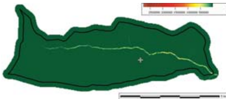
Ryc. 7. Wskaźnik siły spływu, będący miarą potencjalnej siły erozyjnej spływu powierzchniowego przyjmuje najwyższe wartości w dnie doliny i wyjątkowo poniżej zbieżnych partii stoku. Maksymalne wartości pokrywają się z miejscami lokalnego zwiększenia spadku podłużnego koryta i przewężenia doliny.
