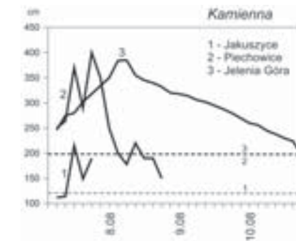
Ryc. 4. Odczyty stanów wody na Kamiennej podczas wezbrania w sierpniu 2006 r. według danych IMGW. Wartości podano dla trzech różnych punktów pomiarowych w górnym (Jakuszyce), środkowym (Piechowice) i dolnym (Jelenia Góra) biegu rzeki. Poziome linie oznaczają wysokość stanu alarmowego dla każdego z wodowskazów.
