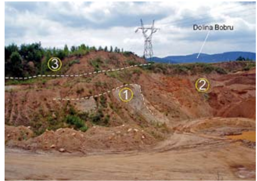
Fot. 2. Widok na południową ścianę wyrobiska żwirowni w Janowicach Wielkich. Objasnienia: 1-podłoże granitowe, 2-osady rzeczne i wodnolodowcowe, 3-nadkład (fot. A. Traczyk).
