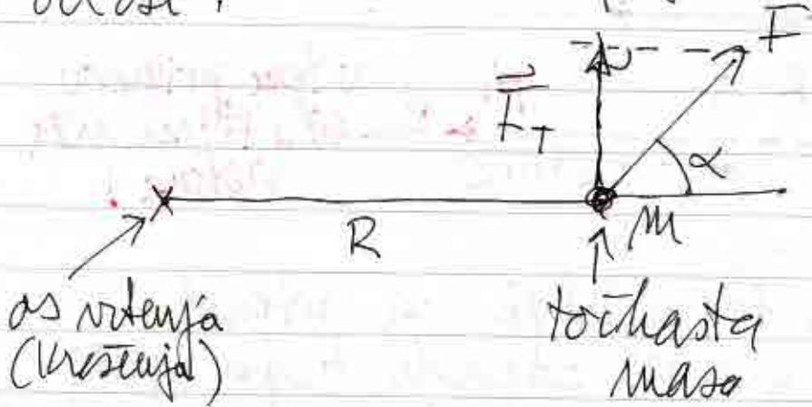
Na točkasto maso deluje sila  $\vec{F}$ , pod likom  $\alpha$  glede na  $R$ . Vzenuj lahko povzroča samo tangentna komponenta sile  $\vec{F}$ :
