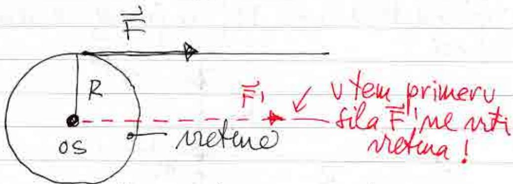
Vrsta s silo  $\vec{F}$  povečuje na vreteno v smere tangente in zradi tega vrti vreteno. Videli bomo da je za natančnost vrtanja pravilna sila  $\vec{F}$ , peluta  $R$  in smer  $\vec{F}$  glede na  $R$ .
