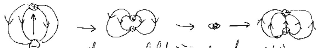
vibracijski električni dipol:  $d(t)$ , mka
