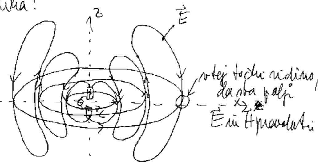
Če gremo od el. dipola <sup>radiče</sup> na modelu, vidimo, da sta palji  $\vec{E}$  in  $\vec{H}$  vedno povezani med seboj, in ta povezava:
