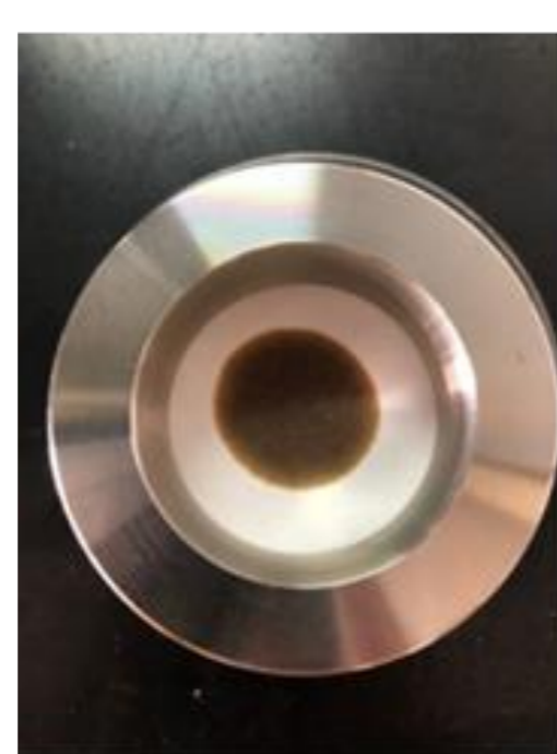
圖二、滴點標準測試
