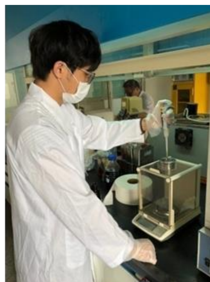
圖二、滴點標準測試
