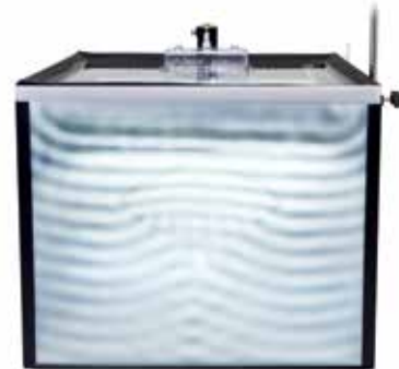
水波在“凸透镜”中的折射
