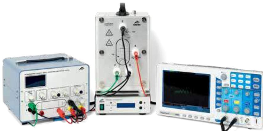
汞的弗兰克-赫兹实验
