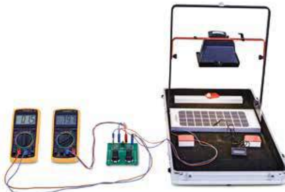
太阳能模块的输出功率与温度的关系
