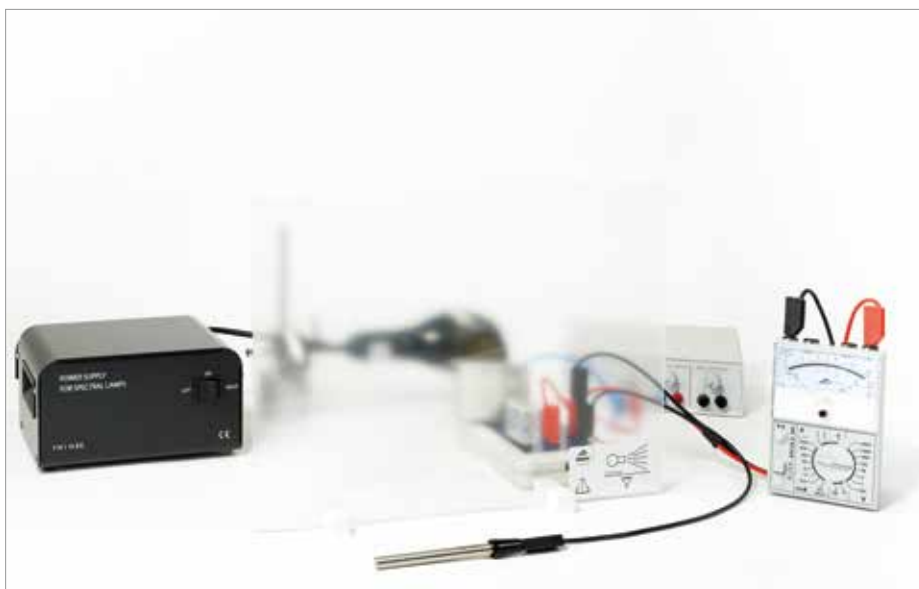
外部光电效应和高压汞气灯
