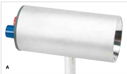
测量莱斯利立方体辐射的热量
