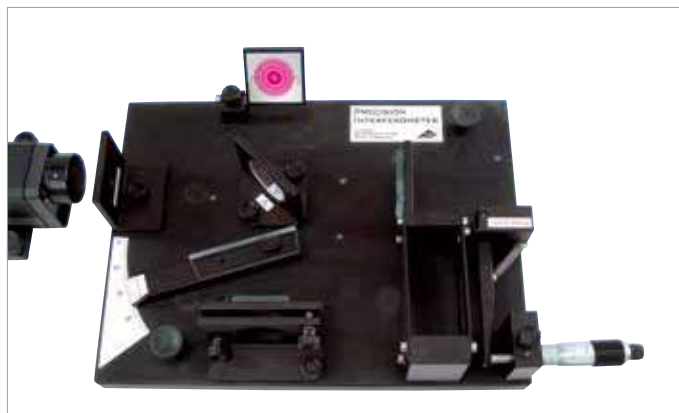
迈克尔逊干涉仪光束路径上的玻璃板
