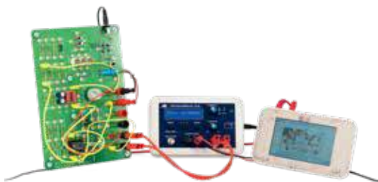
RLC 串联谐振电路的谐振曲线的测量
