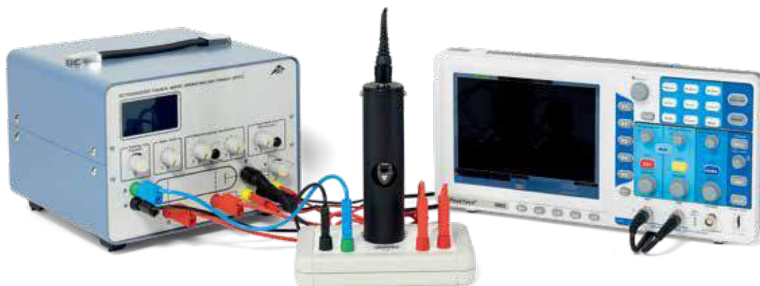
氖的弗兰克-赫兹实验
