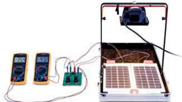
串联太阳能模块的伏安特性
