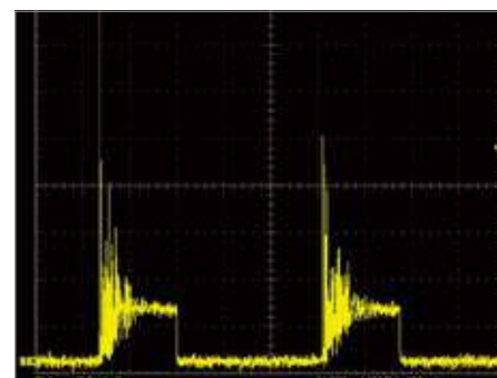
示波图: Nd: YAG 激光器尖峰
