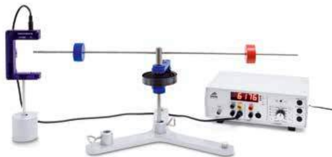
作为其距离旋转轴的半径 r 的函数的重量惯性矩 J
