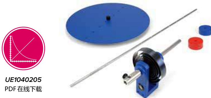
作为其距离旋转轴的半径 r 的函数的重量惯性矩 J
