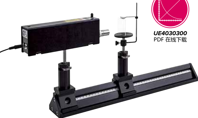
使用菲涅耳双棱镜观察两束光的干涉
