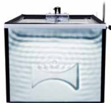
水波在“凹透镜”中的折射
