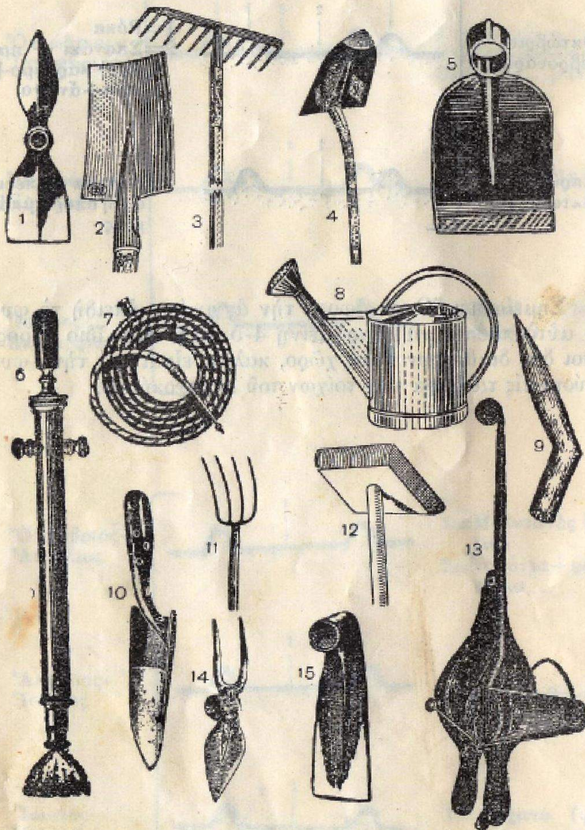
1 σκαλιστήρι, 2 λιογάρι, 3 κτένα (ῥεστέλλο), 4 φινάρι, 5 τσάπα, 6 τρομά για ρανίσματα, 7 σωλήνας ἀπὸ καουτσούκ, 8 ποτιστήρι, 9 φυτευτήρι, 10 ξεριζωτήρι, 11 πηροῦνι, 12 κόπανος, 13 θειαφιστήρι, 14 σκαλιστήρι διχαλωτό, 15 ἄξινα.
