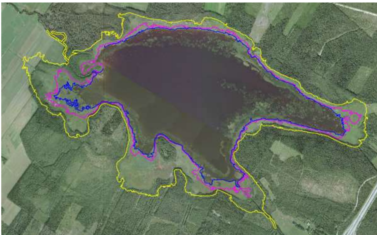
Karta 7. Höjdkurvor i anslutning till Ostträsket som översiktligt redovisar hur vattenytan breder ut sig vid olika scenarier på en nivåhöjning. Nuvarande vattennivå ligger på 16,5m.ö.h. 16,75 m.ö.h. (blå), 17,0 m.ö.h. (lila) och 18 m.ö.h. (gul). Höjddata från Lantmäteriets laserscanning/Nationella höjddata.
