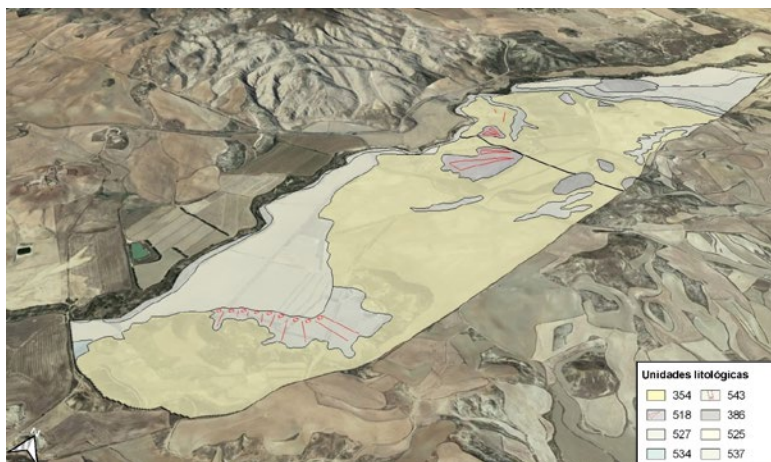
Ilustración 69. Litología de la finca Los Aguilares. (Fuente: Tracasa Instrumental y Gobierno de Navarra, Dirección General de Obras Públicas).
