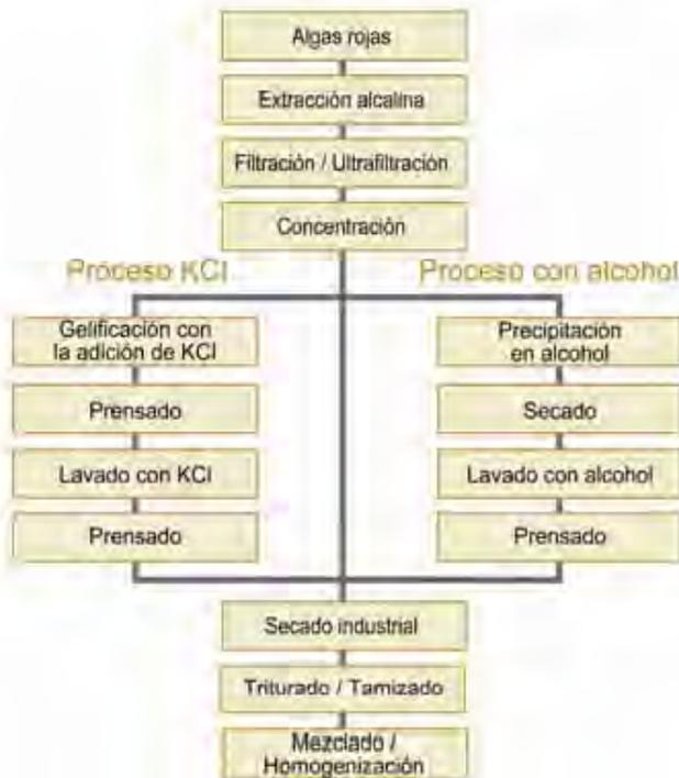
Fig. II.2. Proceso de extracción a nivel industrial de los carragenanos refinados. Fuente: Cargill Texturizing Solutions ([http://www.cargilltexturizing.es/products/hydrocolloids/carrageenans/cts\\_prod\\_hydro\\_car\\_man\\_es.shtml](http://www.cargilltexturizing.es/products/hydrocolloids/carrageenans/cts_prod_hydro_car_man_es.shtml)).
