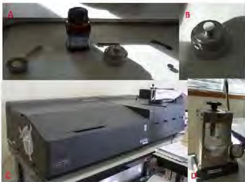
**Fig. II.5. Proceso de elaboración de las pastillas con Bromuro de Potasio. A) Mortero con la muestra y 4 mg aprox. de Bromuro de potasio. B) Pastilla obtenida de la prensa hidráulica. C) Espectrofotómetro FTIR modelo RS/1 (UNICAM). D) Prensa hidráulica Perkin Elmer.**
