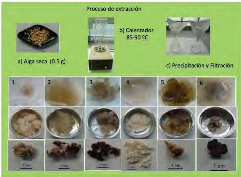
Fig.II.4. Proceso de extracción de carragenano y las diferentes texturas presentadas por cada método de extracción. 1) Freile-Pelegrín et al. (2006), 2) Fostier et al. (1992) natural, y 3) Fostier et al. (1992) alcalino, 4) Ohno et al. (1996) ácido, 5)
