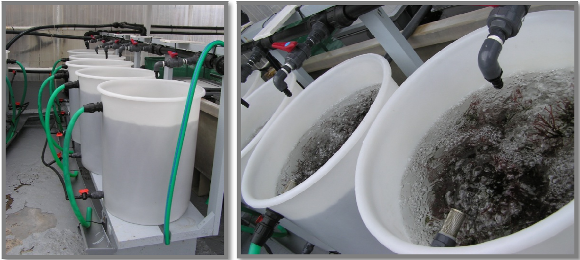
Figura 12 Tanques de 90 l en el Instituto Canario de Ciencias Marinas. Izquierda: vista lateral, tanques dispuestos en la plataforma. Derecha: vista cenital, detalle de la entrada y salida del agua (Fotografía de la autora).
