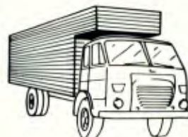
Sobre cabine, a carroceria se projeta sobre a cabine dando maior aproveitamento de espaço.
