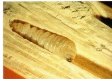
Foto 6. Larva d' Hylotrupes bajulus perforant galeries a l'interior de la fusta de pi.
