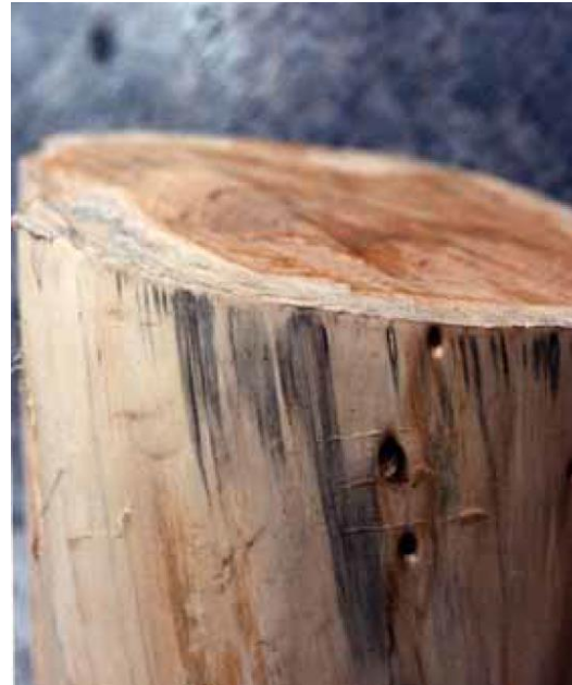
Azulado originado por infección de hongos cromògenos, en la albura de madera de ciprés recién apeada.
