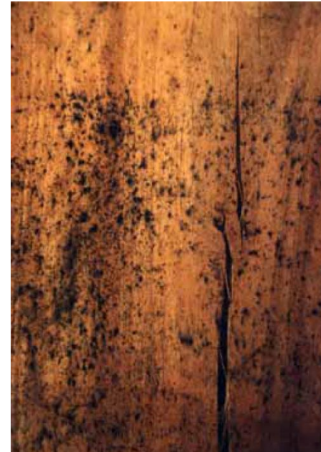
Ataque azulado originado en la madera de eucalipto blanco durante el secado
