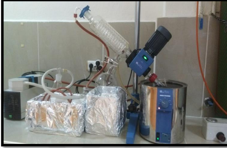
Şekil 3.9. Bitki özütlerinin evaporatörde eldesi
