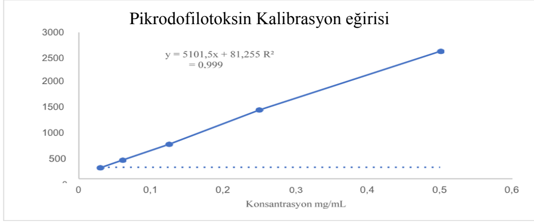
Şekil 3.5. Pikropodofilotoksin'in kalibrasyon eğrisi
